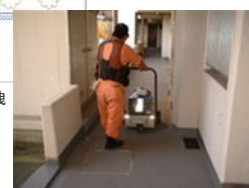
マンション排水管漏水に伴う地下探査
